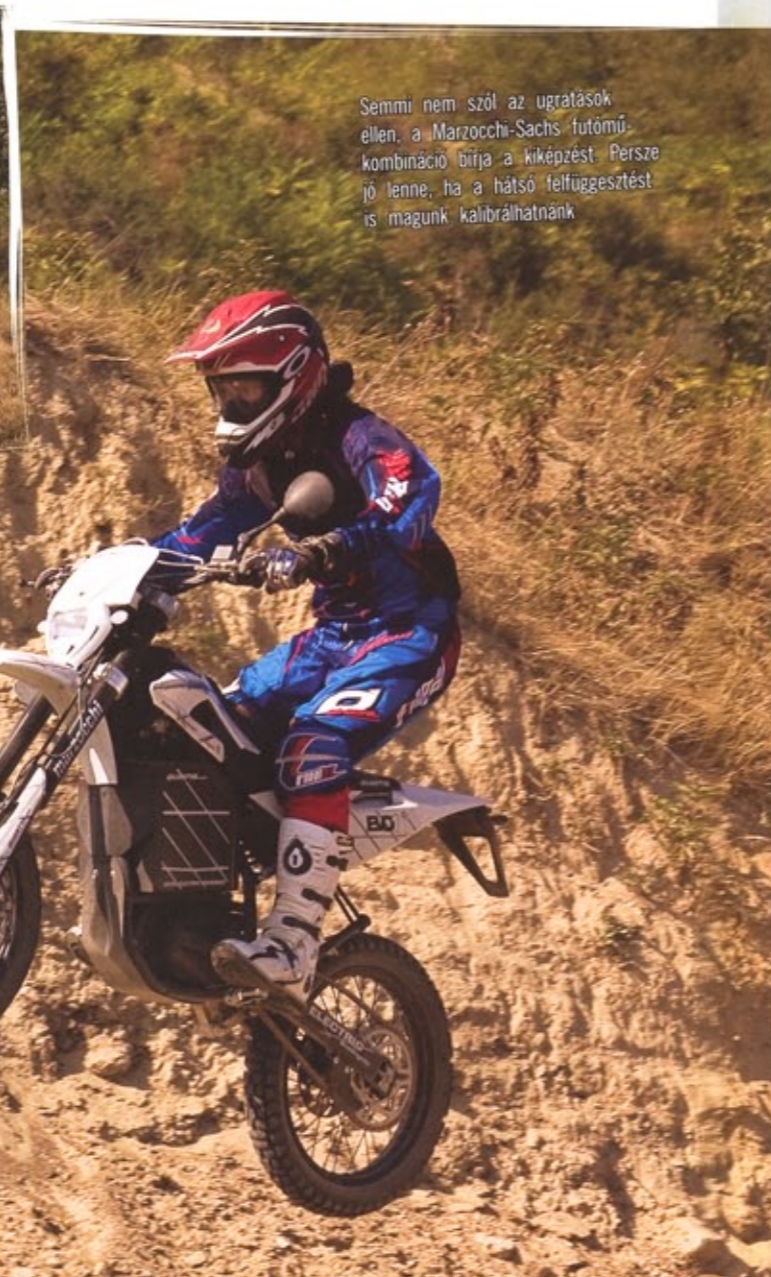
Nemcsak laza talajon: hanem aszfalton is elkapar egy erősebb gázadásnál a Quantya, hiszen az elektromotor nyomatékleadása lineáris. Teljes terhelés esetén kb. negyven percig használható.
