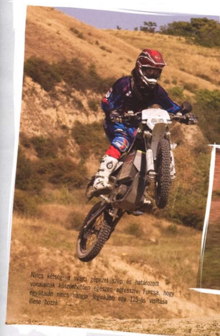
A 48 voltos lítium-polimer akkival 67 km/órás sebességet sikerült elérnünk. Állítólag hamarosan jön a 72 voltos, erősebb változat.
